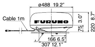
Capteur radar radiateur 3.5 ft X-Class 20.0 kg 44.1 lb
