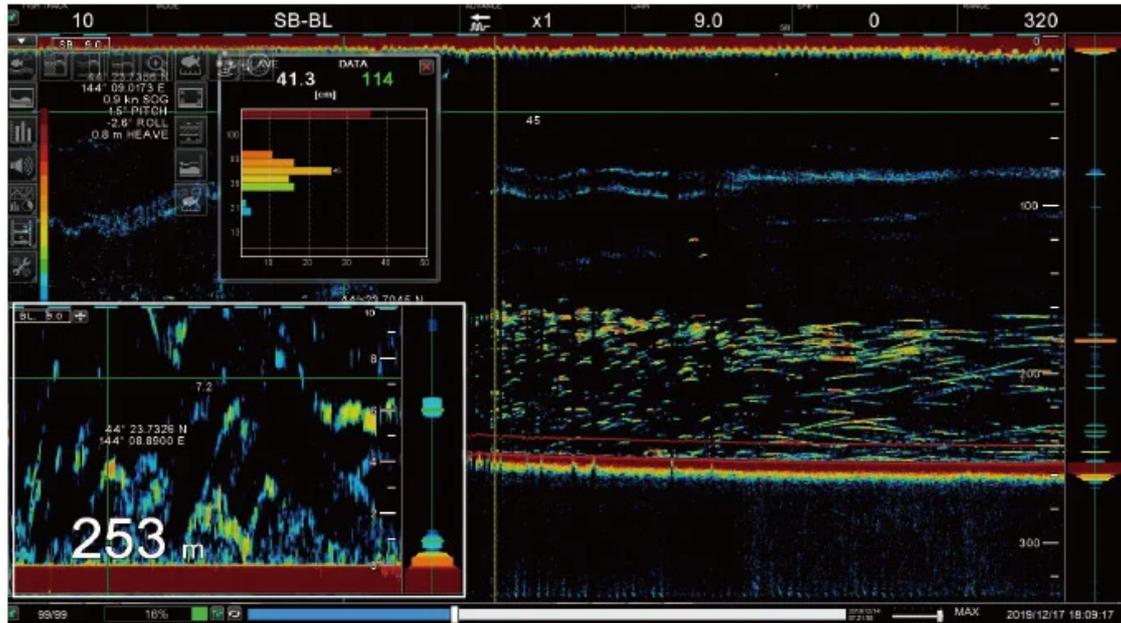
Le FCV38 est conçu comme un sondeur black box (boîte noire) haut de gamme doté d'une fonction graphique de taille de poisson avec technologie à faisceau divisé. Un faisceau fin, basse fréquence de 38 kHz et de haute puissance de 4 kW qui permet d'obtenir l'image d'écho claire d'un banc de poissons et de fonds marins même en grande profondeur (jusqu'à 1500 m).
