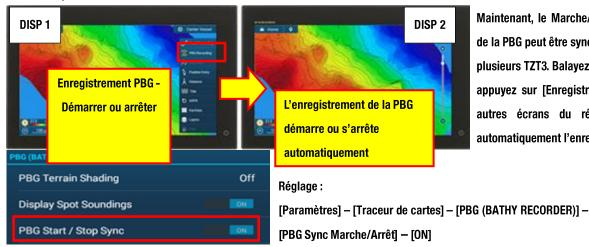
Maintenant, le Marche/Arrêt de l'enregistrement de la PBG peut être synchronisé dans le réseau de plusieurs TZT3. Balayez le bord sur le côté droit et appuyez sur [Enregistrement PBG], afin que les autres écrans du réseau démarrent/arrêtent automatiquement l'enregistrement PBG.
