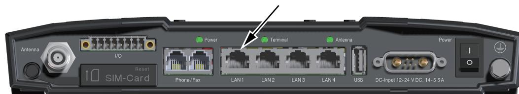
4. セーフティボイス用のハンドセットを通信制御ユニット、または通信制御ユニットと同ネットワーク上のイーサネットスイッチに接続します。
